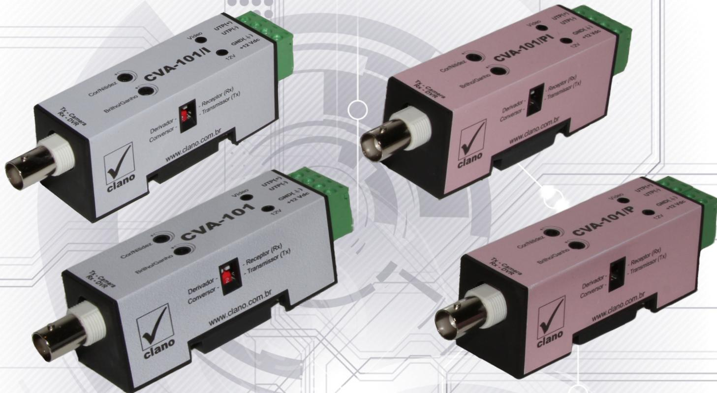
Converte, amplifica e equaliza o sinal de vídeo das câmeras de segurança para serem usadas com cabos UTP de até 1800 metros. Pode ser usado para transmitir ou para receber o sinal de vídeo. Possui Leds indicadores de alimentação e sinal de vídeo. Seu gabinete segue ao padrão DIN, facilitando e padronizando a instalação.
